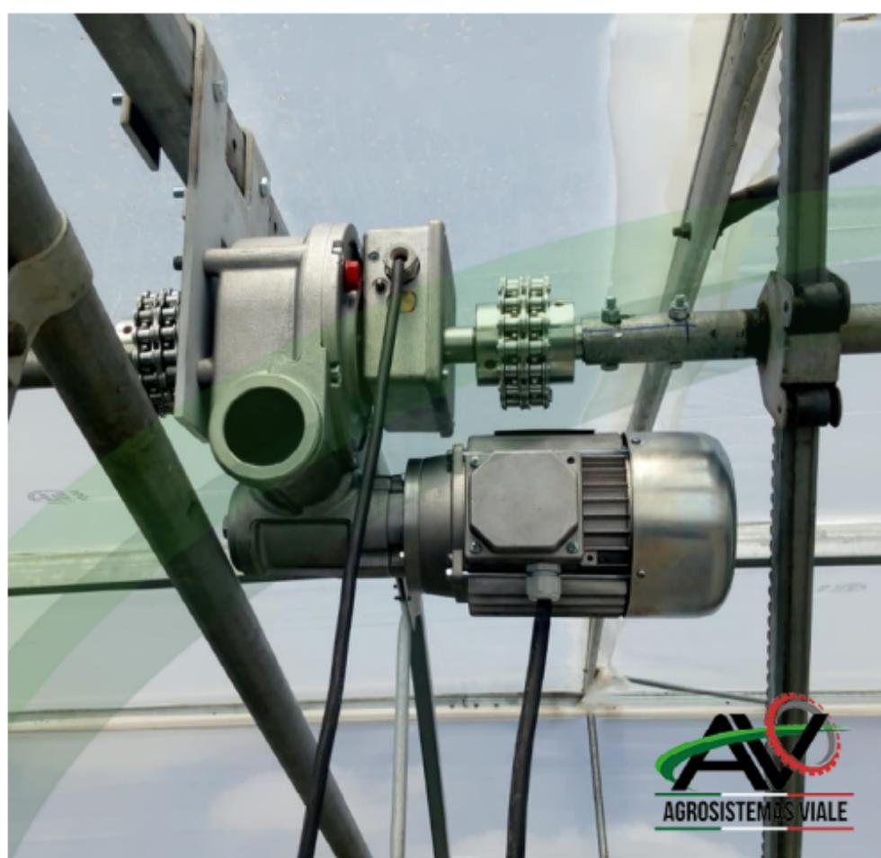
Su acoplamiento es directo al tubo de mando con catarinas y cadena doble. El final de carrera, con doble micro de seguridad y son muy fáciles de calibrar.
